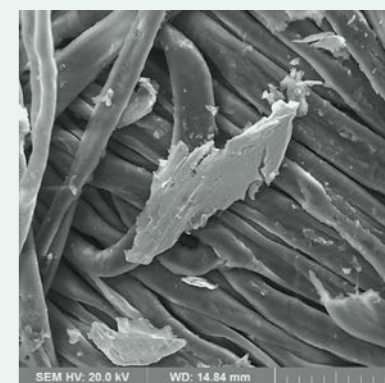
Металлические частицы в натире на бязи
